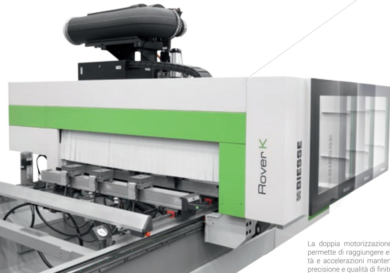
La doppia motorizzazione nell'asse X permette di raggiungere elevate velocità e accelerazioni mantenendo un'alta precisione e qualità di finitura.
