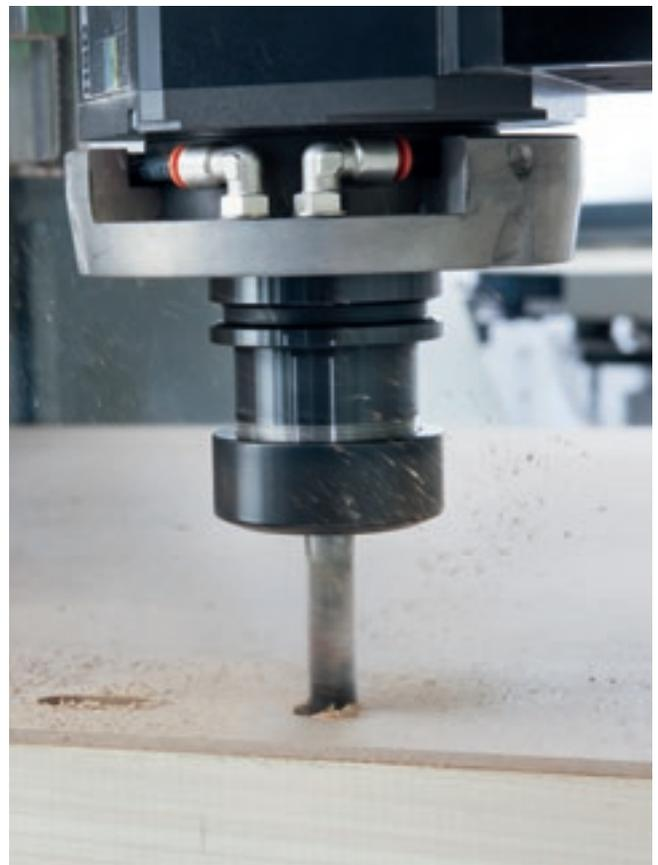
Rover K Smart è dotata di 3 o 4 assi indipendenti e interpolanti e può essere equipaggiata con aggregati in grado di eseguire tutte le lavorazioni sia su pannelli che elementi in massello.
