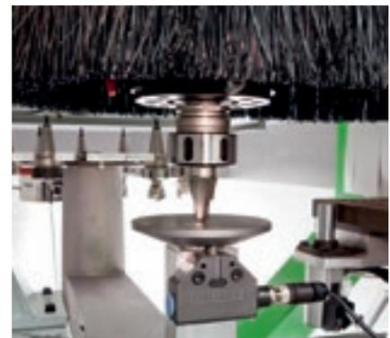
Reducción del tiempo necesario para el equipamiento de la máquina sin posibilidad de que el operario pueda cometer ningún error gracias al Presetter por contacto, que permite medir automáticamente la longitud de la herramienta.
