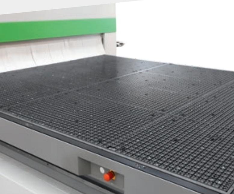
Tecnología multizona que adapta de manera eficiente y automática el vacío de la máquina a los diversos tamaños de tablero que tiene el cliente en su producción.
