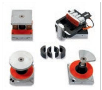
Bloqueo de piezas colocadas en contra-plantillas especiales con vacío.
