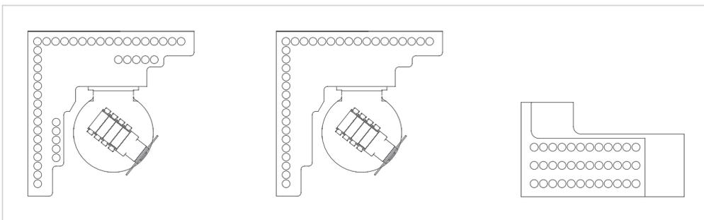
Cabezales de taladro BHC42-BHC32-BH36 wde hasta 8000 rpm.
