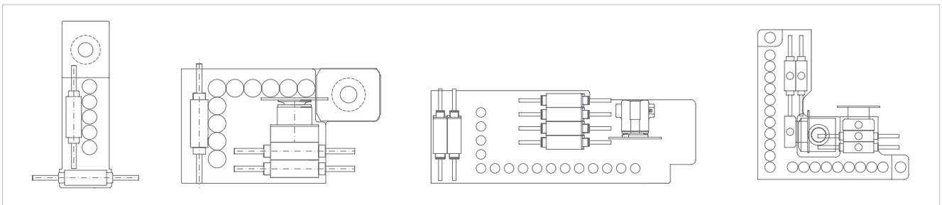
Cabezales de taladro disponibles de 9 a 30 herramientas: BHZ 9 - BHZ 17 L - BHZ 29 L - BHZ 30 2L de hasta 6000 rpm.
