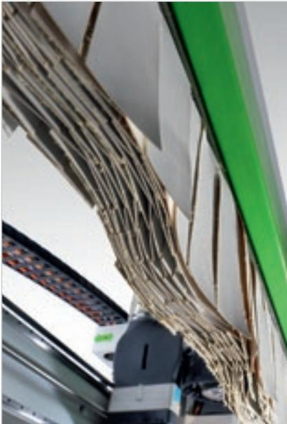
**Bandas laterales** para la protección del grupo operador, móviles para trabajar a la máxima velocidad con total seguridad.
