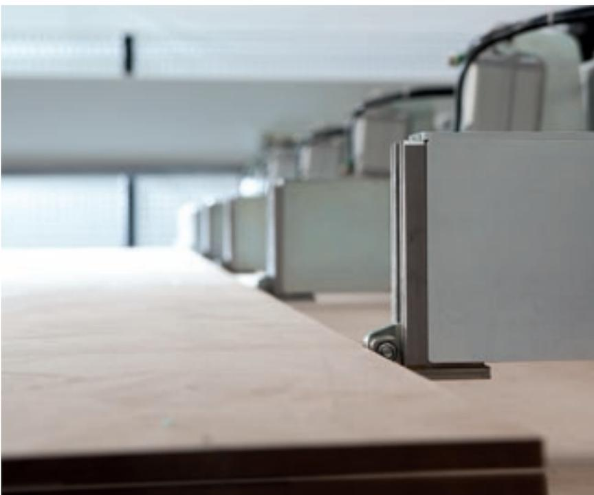
Las **pinzas** recogen automáticamente la cantidad necesaria de paneles en base al esquema de elaboración incrementando la eficiencia y la seguridad de la seccionadora sin aumentar sus dimensiones.
