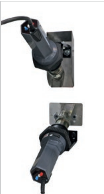
Heißluftaggregat für die Reaktivierung der Kantenfarbe.
