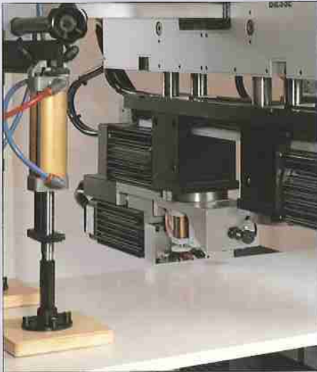
Unit for back, horizontal boring operations. Einheit für hintere Horizontalbohrungen.
