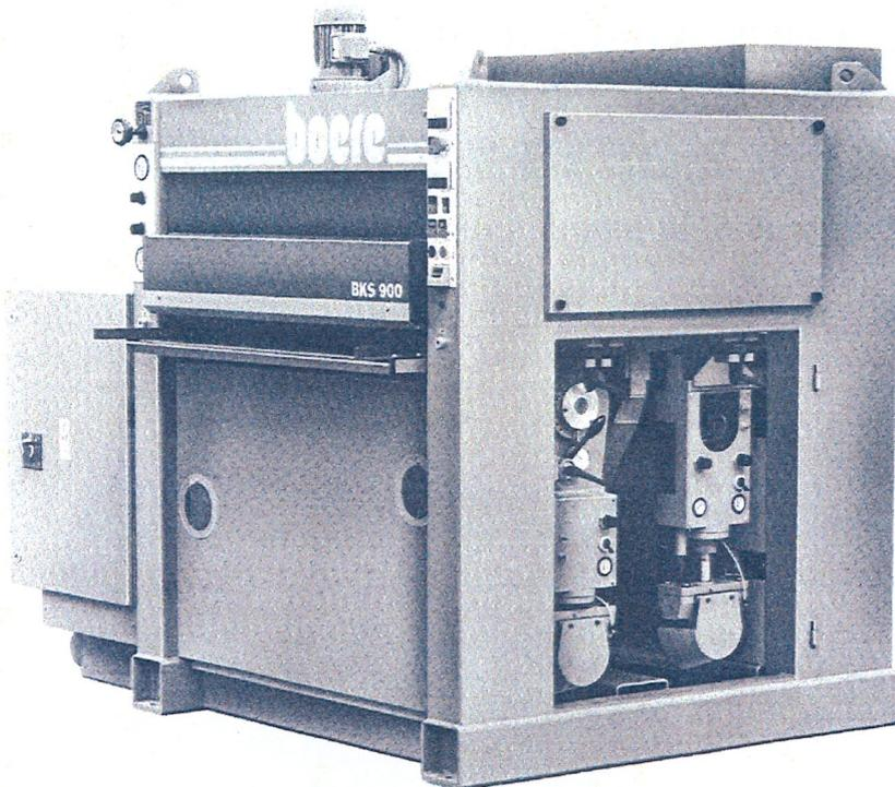
**Boere – Waddinxveen-Holland** hat eine gut 40-jährige Erfahrung im Maschinenbau zum Ausdruck gebracht in u.a. erneuerten Modellen der untenschleifenden Breitbandschleifmaschinen.
