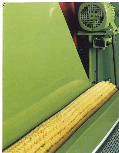
Dispositif de brossage incorporé
