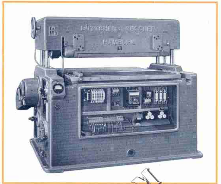
Einzugsseite mit geöffnetem Schaltschrank
