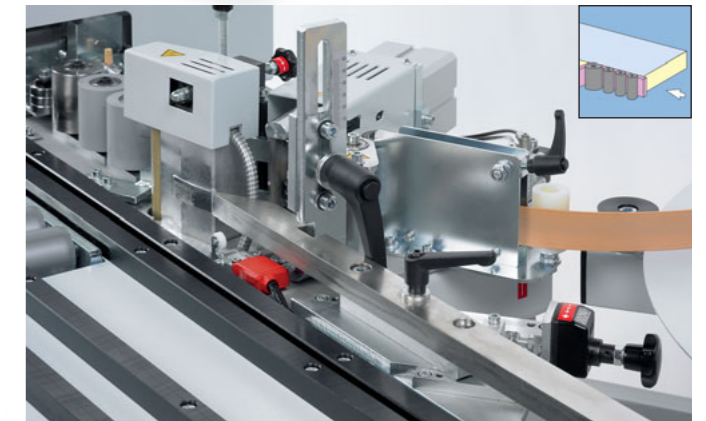
Verleimaggregat + Druckzone Agrégat d'encollage + zone de pression Gruppo di incollaggio + zona di pressione
