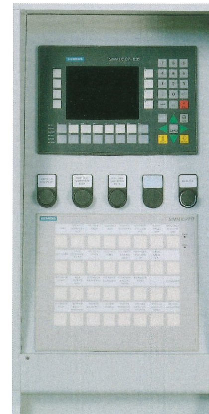
SPS-Steuerung Siemens S 7: Datenübertragung über Bus-System. Zentrales Bedientableau IBT. Durch Eingabe der Werkstückabmessungen werden alle Stellachsen, die Liniendrucke der Kaschierwalzen, Folienzug und Heizbreite automatisch der Werkstückbreite angepasst. Diagnoseanzeige für alle Anlagenteile.
