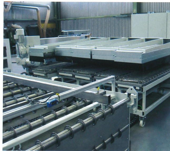
IR-Zone (ausfahrbar) zur Plattenvorwärmung IR zone (retractable) for preheating the boards
