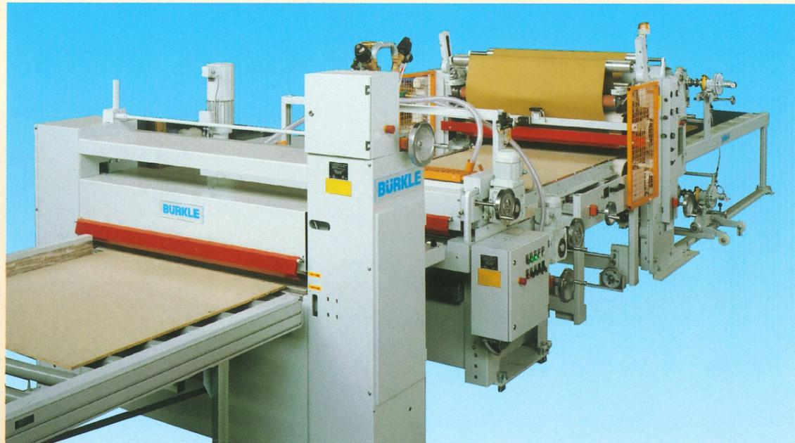
Das Modell EFA ist die Basisausführung zum Kaltkaschieren von Span-, MDF- und Hartfaserplatten mit Dekorfolien. Eingesetzt wird Dispersionskleber, gegebenenfalls auch Harnstoffharz bei Folien mit Härterückstrich.
