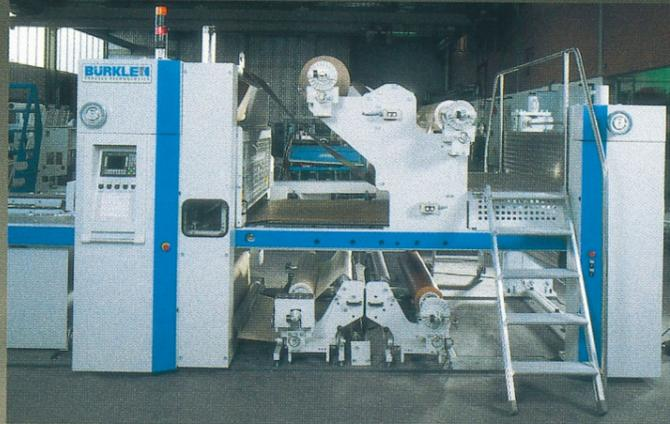
**FOLIENABWICKELSTELLEN MIT FOLIENVERBINDUNG und Nahtstellensteuerung (Option)**
