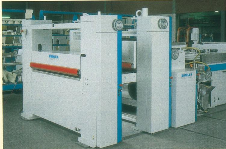
QUERBÜRSTMASCHINE für gleichmäßige Entstaubung
