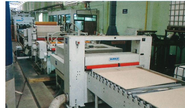
Bürstmaschine für optimale Entstaubung Brushing machine for an optimal dust removal
