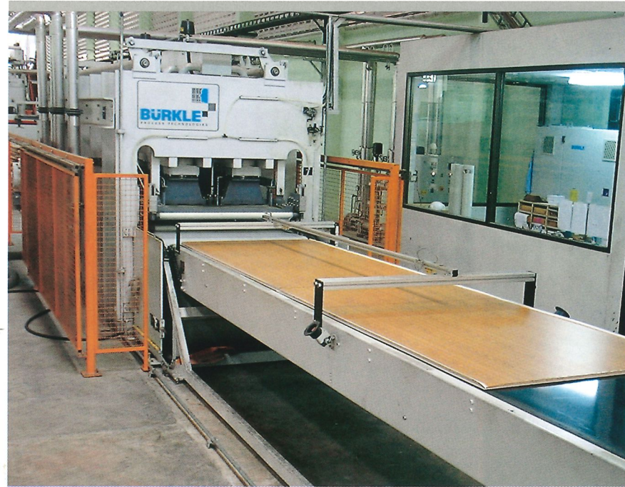
Einetagen-Pressen für optimale Oberflächenqualitäten One-daylight press for an optimal surface quality
