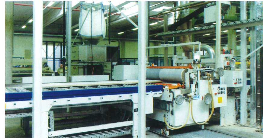
Leimauftragmaschine Glue spreading machine
