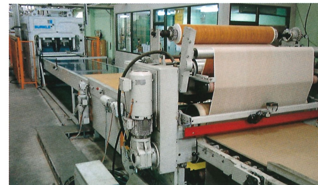
Kaschierstation für ein- oder beidseitiges Folienauflegen Laminating station for single or double sided lamination of foils
