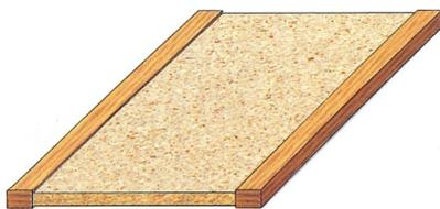
Spanplatte mit Massivanleimer
