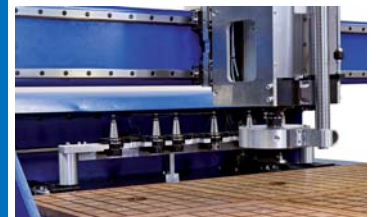
10-fach-Magazin geschützt im Gehäuse, BZT PFH 10-times magazine protected in the housing, BZT PFH
