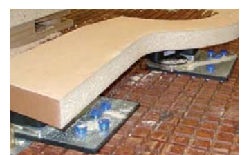
Fräsen mit Vakuum-Aufspanntechnik BZT PFH-2515 Milling with vacuum clamping technology BZT PFH-2515
