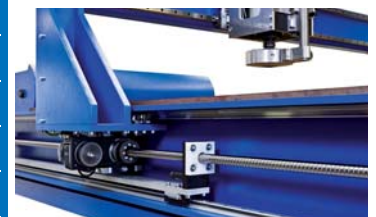
Angetriebene Mutter: links und rechts, BZT PFH Driven screw nut: on the left and right, BZT PFH
