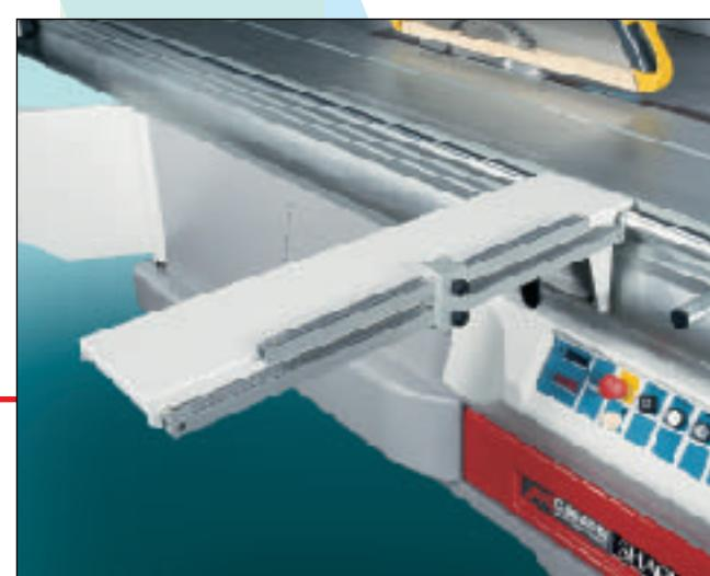
Guida telescopica per tagli inclinati -60°+45° di facile e rapida regolazione. Il suo ampio dimensionamento permette un appoggio sicuro ed un taglio molto preciso. È inoltre possibile eseguire tagli inclinati combinati inclinando sia il gruppo sega che la guida telescopica: ciò conferisce estrema versatilità alla macchina e la rende ideale per qualsiasi tipo di esigenza produttiva.
