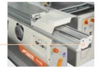
Hardened steel guideways with double prismatic guideway, preloaded ball bearings and hardened sliding ways. Precision, smooth running and absence of maintenance are unique features of the CASADEI sliding table. Rolltisch mit gleitenden Prismenführungen aus gehärtetem Stahl und Zwischenlagerung von Kugeln und gehärtete, genietete Führungen. Genauigkeit, leichter Lauf und Wartungsfreiheit sind einzigartige Eigenschaften des Rollentisches CASADEI.
