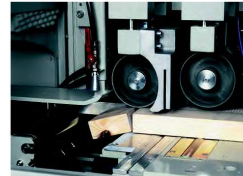
Patentierter Abfallschacht für optimale Restholzentorgung
