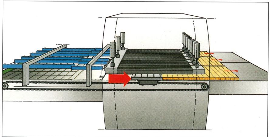
*Einschiebeleiste mit Kettenantrieb bis zum Pressbettende. Ermöglicht ein schnelles und automatisches Entleeren und Füllen bei Dimensionswechsel. Das sichert eine hohe Flexibilität und Produktivität.*
