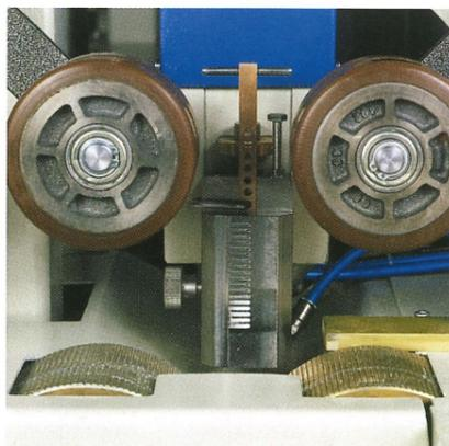
Leim wird präzise auf das Werkstück aufgetragen.
