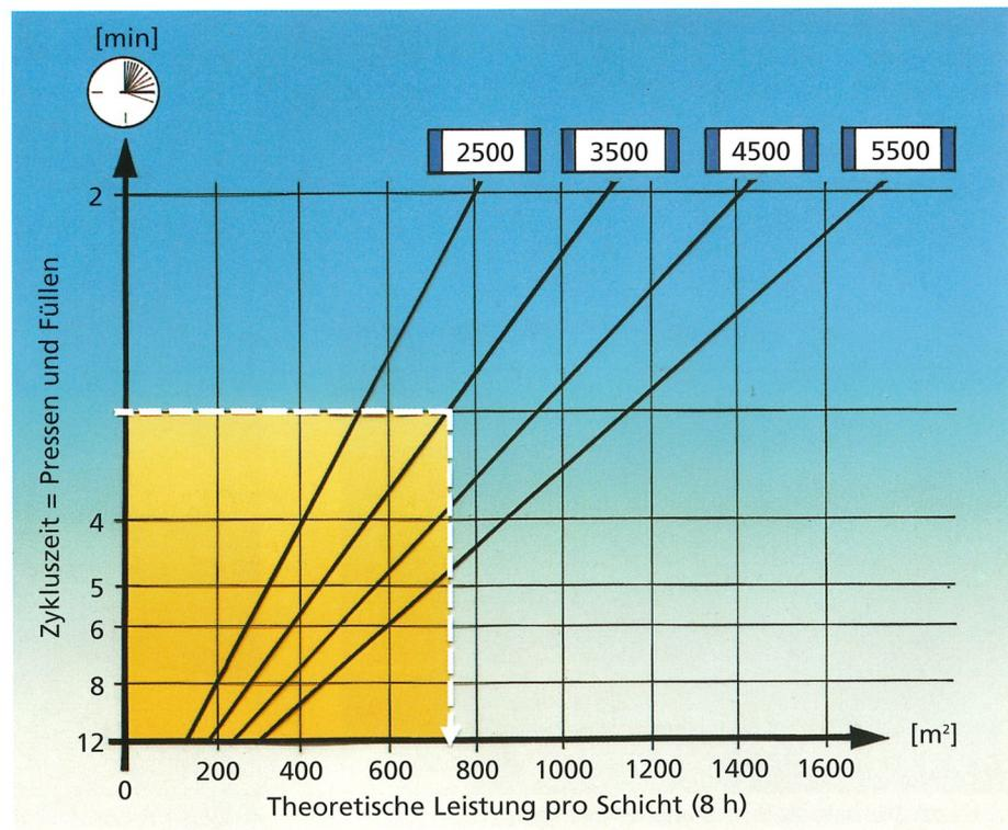
Mit diesem Diagramm kann einfach und schnell die passende Lösung mit ProfiPress ermittelt werden, wenn Leistung, Plattengröße bzw. Presszeit bekannt sind.
