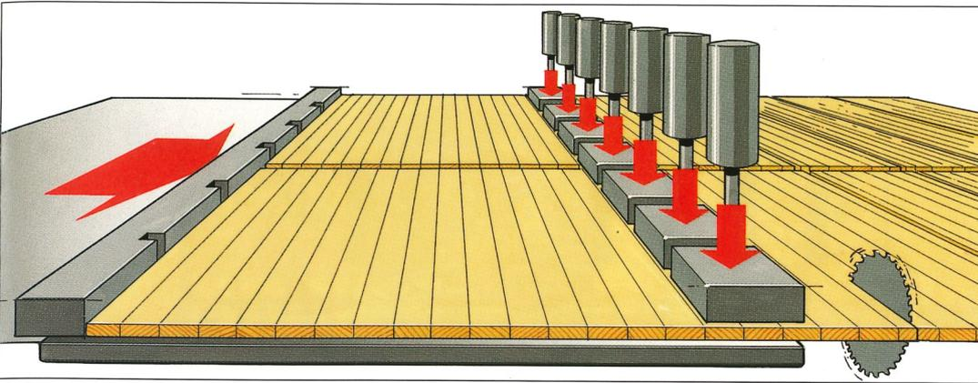
*Neue Technik von Dimter: Hydraulischer Druckschieber vorn und einzelne Brems- und Halteelemente hinten garantieren vollen Verleimdruck auf allen Fugen – und bei Endlosverleimung ist der Sägeschnitt absolut parallel zur Leimfuge!*
