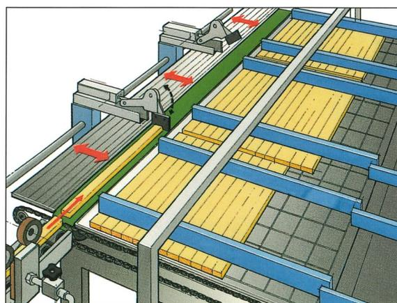
Bei Kurzlängen mehr Lagen nebeneinander – die Pressfläche wird optimal genutzt. Die Anschläge sind manuell oder motorisch positionierbar.
