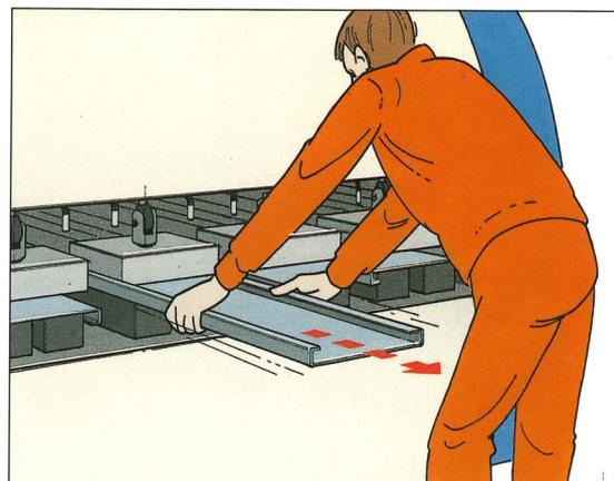
*Neue Technik von Dimter: Pressbett schnell zu reinigen durch leichte, einzelne Profile aus Spezialstahl. Aus- oder einklinkbar in wenigen Minuten – dadurch mehr effektive Produktionszeit!*
