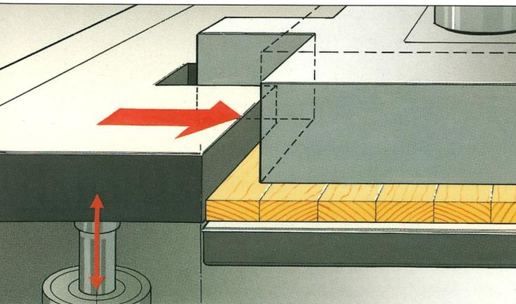
*Neue Technik von Dimter: Beim Wechseln der Holzdicke passt sich der obere Pressentisch und der hydraulische Druckschieber automatisch jeder neuen Dicke an. Zungen im Pressentisch und Schlitze im Druckschieber machen das möglich. Mehr Produktionszeit und keine Bedienfehler!*
