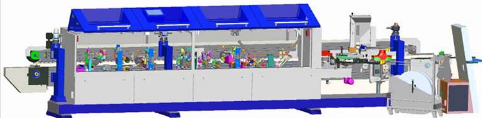
Líquido de limpieza, grupo matacantos oscilante y grupo ranurador neumático.
