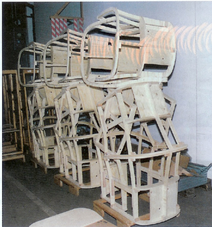
Fertig montierte Sesselgestelle auf dem Weg zur Polsterei
