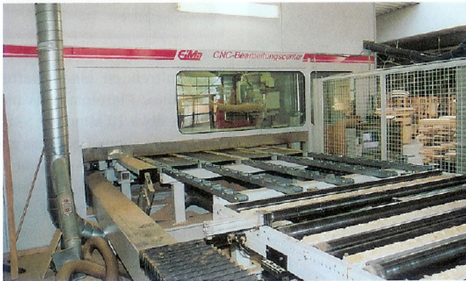
Das Multiplattencenter MC 54 mit der Zuführeinrichtung für Einzelplatten oder Plattenstapel
