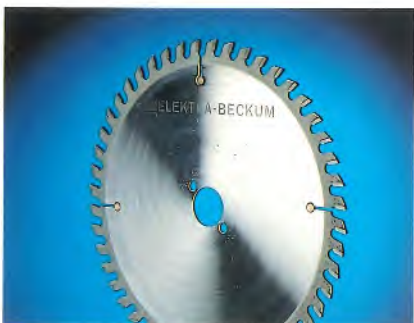
HM 250 x 3,2/2,2 x 30 Z = 48 DH Zum Schneiden von beschichteten Platten. Dieses Spezialblatt ersetzt das sonst notwendige Vorritz-Sägeblatt. Bestell-Nr. 091 001 0166
