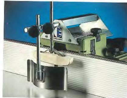
Andruckvorrichtung. Dient zur sicheren Führung des Werkstückes. Bestell-Nr. 091 400 8166
