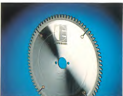
HM 250 x 2,8/2,2 x 30 Z = 80 TF Für Holz, Paneele, Kunststoffe, Alu, Kupfer- und Messingprofile, sowie hochwertig furnierte Platten Bestell-Nr. 091 001 0204
