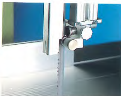
Präzisionsdreirollenführung BAS 350. Bestell-Nr. 090 901 0900 Führungsrolle aus Hartmetall, bessere Ausnutzung und Einsatzmöglichkeiten der Bandsägen, sehr hohe Lebensdauer. Einstellung und Verstellung erfolgt ohne Werkzeug, durch Schräg- stellung erfolgt eine selbstständige Reinigung der Rollen, Grundkörper gehärtet und geschliffen, optimale Führung des Sägebandes.
