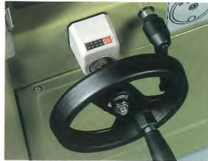
Digitales Anzeigegerät. Ermöglicht die Einstellung beim Dickenhobeln auf 1/10 mm. Nur für HC 320 und HC 410. Bestell-Nr. 091 101 3983
