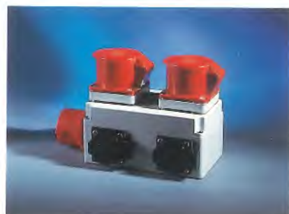
▲ Einschaltautomatik ALV 10: 220 - 240 V/50 Hz / 380 - 400 V/50 Hz Absicherung 16 A/ 400 V IP 44 / Netzanschluß mit Phasenwender 4 Anschraubmöglichkeiten M5 x 7,2 mm Maße: 235 x 106 x 155 mm Bestell-Nr. 091 301 4634
