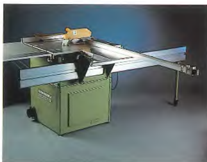
Schiebeschlitten PK. Anschlag mit mm-Aufteilung, ausziehbar bis 2600 mm (Teleskop-Profil); verschiebbarer Anschlagreiter; Führung erfolgt über 4 kugelgelagerte Laufrollen; das Führungsprofil besteht aus dickwandigem Aluminium und verzinkten Rundstählen; einfache Befestigung mit Schnellverschlüssen; ca. 18 kg Gewicht.
