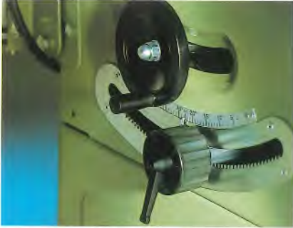
Präzise und stufenlos verstellbar. Die Höhen- und Schrägverstellung bei der PK 300 K.
