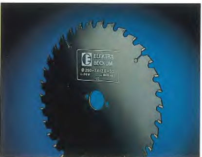
HM 250 x 3,0/2,0 x 30 Z = 34 W Universell einsetzbar für Längs- und Querschnitte, auch Spanplatten (wird in der Serienausstattung geliefert). Bestell-Nr. 091 001 0158
