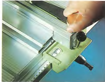
Feineinstellung. Der Parallelanschlag ist serienmäßig mit Lupe ausgestattet.
