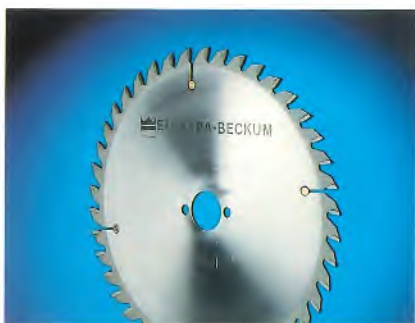
HM 250 x 3,2/2,2 x 30 Z = 42 UW Zum Schneiden von Möbelementen, furnierten Platten, beschichteten Platten und Massivhölzern. Bestell-Nr. 091 001 0174
