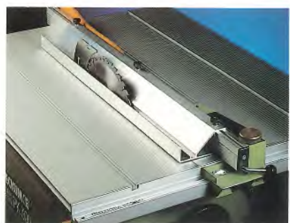
Schneidlade. Zum präzisen Sägen von Rundstäben und Vierkanthölzern. Bestell-Nr. 091 000 4018
