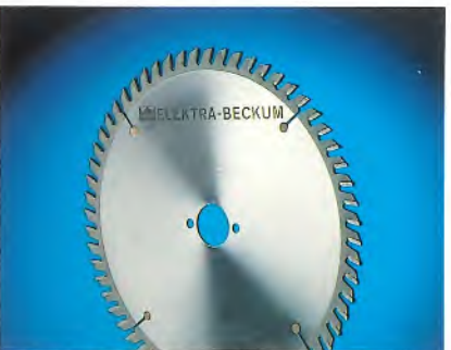
HM 250 x 3,2/2,2 x 30 Z = 60 KW Zum Schneiden von Kunststoffplatten, Profilen und Kunststoffen aller Art. Bestell-Nr. 091 001 0182
