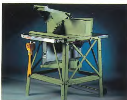
Rundholzschneidvorrichtung. Vorge- schrieben beim Sägen von Rundhölzern. Max. Ø 125 mm bei Sägeblatt-Ø 450 mm, Max. Ø 75 mm bei Sägeblatt-Ø 400 mm. Bestell-Nr. 091 000 8862
