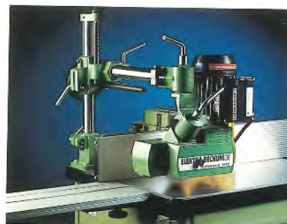
Vorschubapparat TF 904. Der besonders handliche Vorschubapparat mit drei Vorschubrollen gleicht Materialstärken-Differenzen bis 12 mm vollständig aus. Er ist auf Vor- und Rücklauf umschaltbar. Das Universalstativ mit Schnellverstellung ist horizontal, vertikal und schräg einstellbar. Die drei Vorschubrollen sind einzeln gefedert und werden von einem starken Motor angetrieben.
