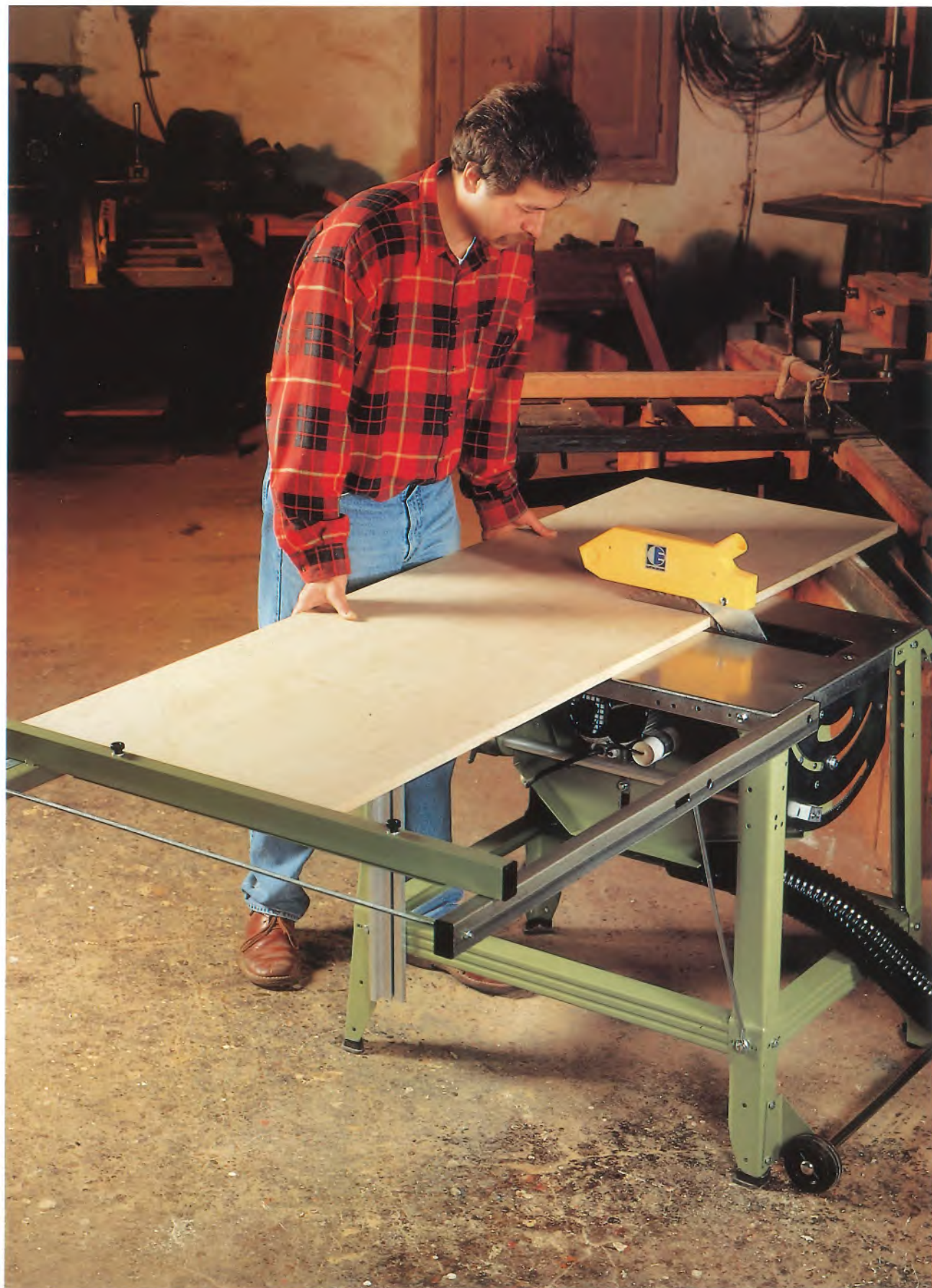
◀ Gut abgeschnitten. Die Plattenschneid- einrichtung für Platten bis 1250 mm Breite. (Zubehör)
