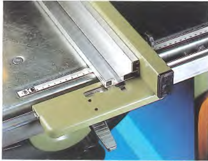
Winkelgenauer Parallelanschlag mit Exzenterklemmung.
