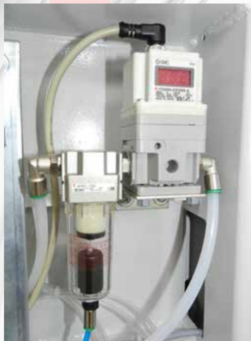
Valvole proporzionali elettroniche Electronic proportional valves
