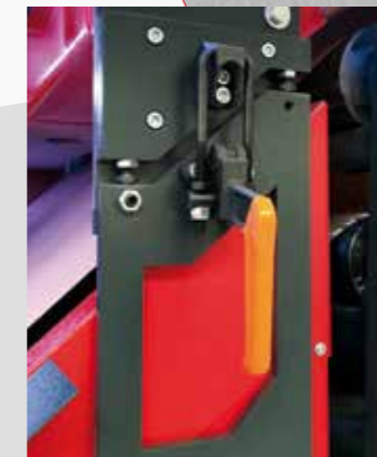
Blocco manuale per cambio nastri (con sicurezza intrinseca) Manual lock for belt changing (intrinsically safe)
