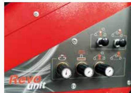
Controlli pneumatici Pneumatic control
