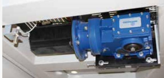
Posizione e fermo giostra 0/360° (MOTORE BRUSHLESS ROTAZIONE) Carousel positioning stopping 0/360° (BRUSHLESS MOTOR ROTATION)
