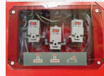
Valvole proporzionali elettroniche Electronic proportional valves
