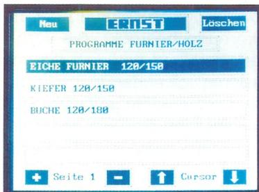
Auch dieses System ist transparent, der Bediener sieht die im Programm abgelegten Parameter, d.h. die Verbindung **Mensch-Maschine** bleibt erhalten, das Ablegen eines zusätzlichen Programmes ist spielend möglich. Die Programme werden durch einfaches Berühren der Zeile abgerufen.
