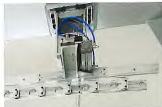
Magazynek listwowy z ochroną przeciwpyłową Slatted magazine with dust protection
