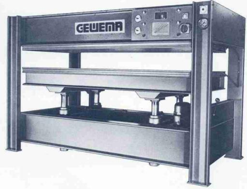
s Hydrauliksystem besteht aus einer kombierten Nieder-Hochdruckpumpe, die in der lederdruckstufe ein schnelles Schließen der atte gewährleistet, in der Hochdruckstufe ne Platten mit dem gewünschten Druck anmeßt und automatisch abschaltet. Eine Patent- + dichtung gewährleistet eine gute Öldiching, die nicht nachgestellt werden muß. fezialringe sorgen für eine einwandfreie uberung der Kolben.
