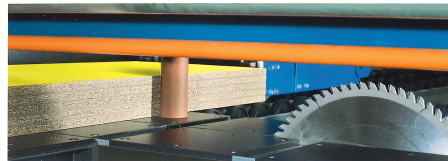
Während des Schnittvorganges sind die Schutzlamellen immer abgesenkt. Les volets sont toujours abaissés durant le cycle de coupe.
