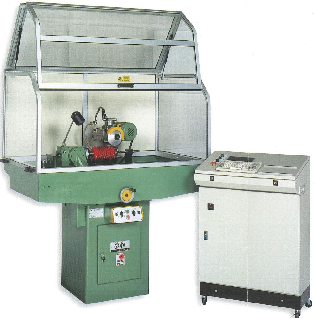
① La F36-CN-2A è stata concepita per la riafilatura automatica degli utensili per la lavorazione del legno, sia a tagliente diritto che a sviluppo elicoidale.
