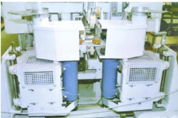
→ Auslauf mit 2 Fräsaggregaten
