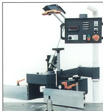
► **Guide à réglage micrométrique de l'ensemble ou de la lèvre avant. Buses d'aspiration incorporées au guide et sous la table. Protecteur escamotable assurant confort et sécurité.**
