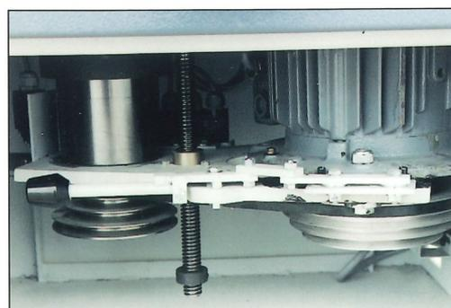
► **Porte située à l'avant de la machine permettant l'accès à toute la partie mécanique. Positionnement facile de la courroie selon la vitesse désirée. Affichage des vitesses sur cadran lumineux.**
