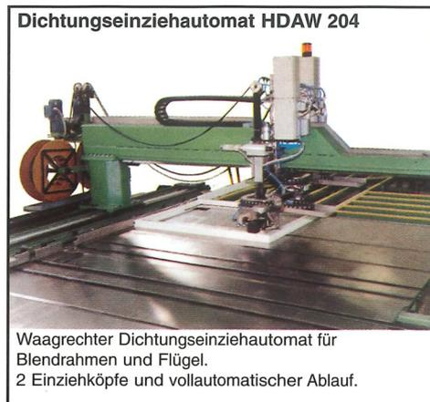
**Dichtungseinziehautomat HDAW 204**
