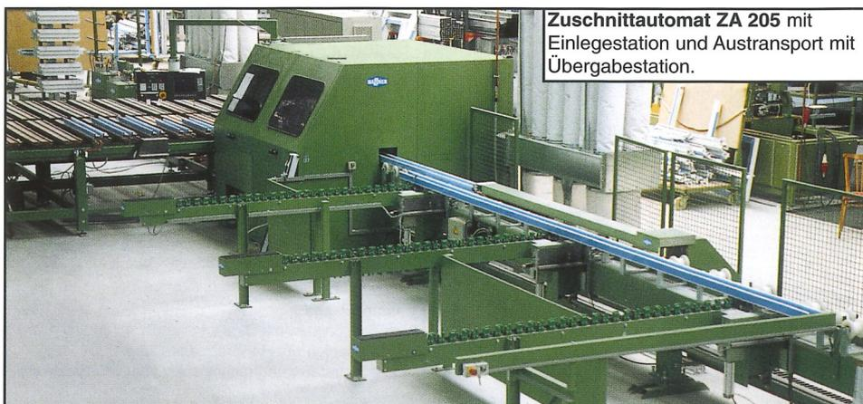
**Zuschnittautomat ZA 205** mit Einlegestation und Austransport mit Übergabestation.
