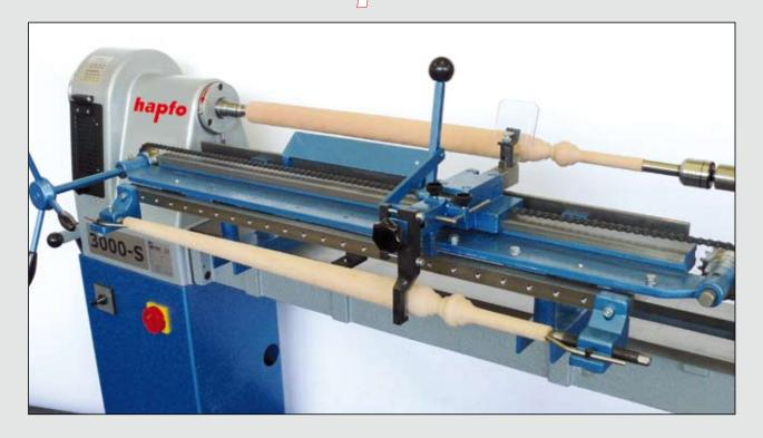
Die Kopiereinrichtung KA-90 erweitert jede Handdrechselbank zu einer leistungsfähigen Kopierdrehbank. Diese kann sowohl längs (z.B. für Sprossen) als auch quer für das Kopieren von Tellern, Schalen und Scheiben montiert werden.
