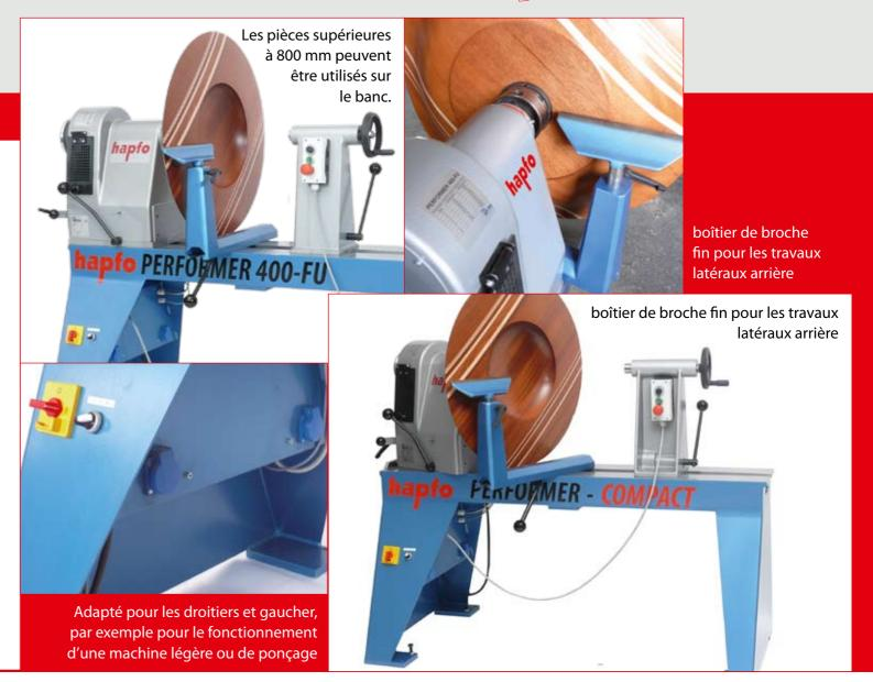
Adaptateur pour accessoires des tours hapfo avec 35mm de centrage disponibles. Repose-main en fer (275 mm), avec dégagement rapide
