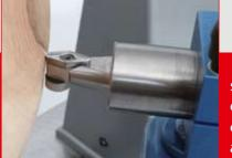
support d'outil avec un cutter de coupe HSS pour la découpe finale. changement d'outil rapide grâce au support d'outil 180°
