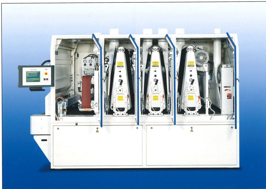
Kreuzschleifautomat für eine einwandfreie Flächenbildung
