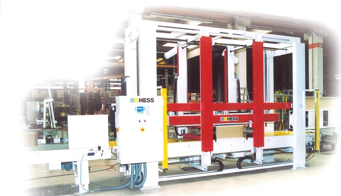
Hess-Formatic-linear-Druchlauf- presse. Maßabfragung über gespeicherte Datensätze oder mit Datenverbund Online. Schwere Bauweise.
