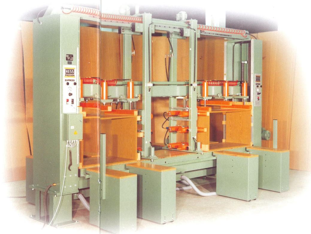
Hess-Sonderpresse, elektrohydraulisch, 1-stationig (auf Basis der Tischpresse). Arbeitsbereich: 1450 x 450 mm. Anschlaghöhe: 400 mm. Zum Ver- pressen von Lautsprecher-Boxen.
