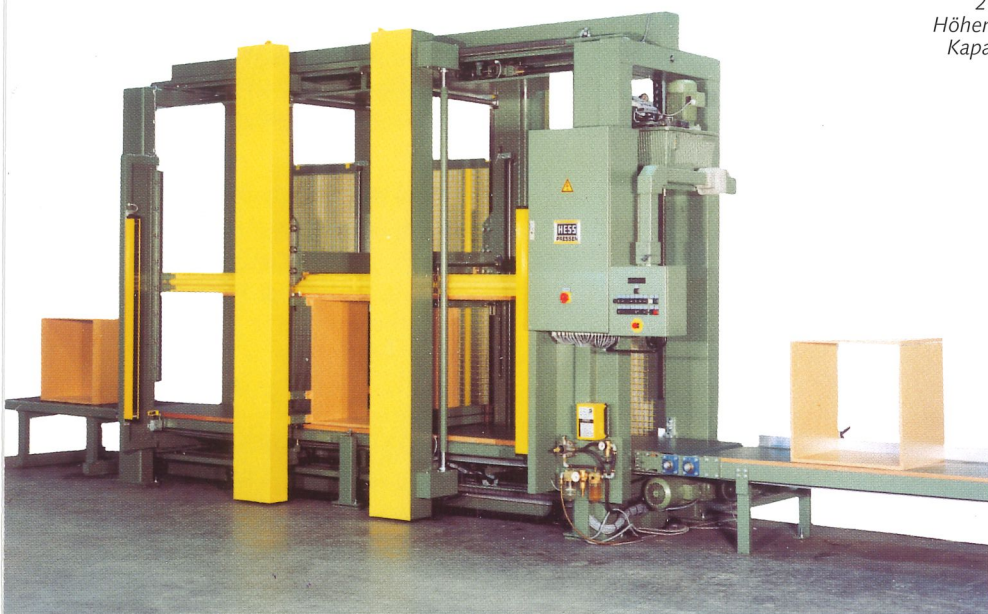
Hess-Formatic-linear-Durchlaufkorpus- presse mit automatischem Pressablauf und Durchtransport. Maßerkennung über Opto-Elektronik. Schwere Bauweise.
