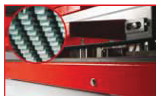
Lamellenband zum Werkstücktransport multi-fin work piece feeder
