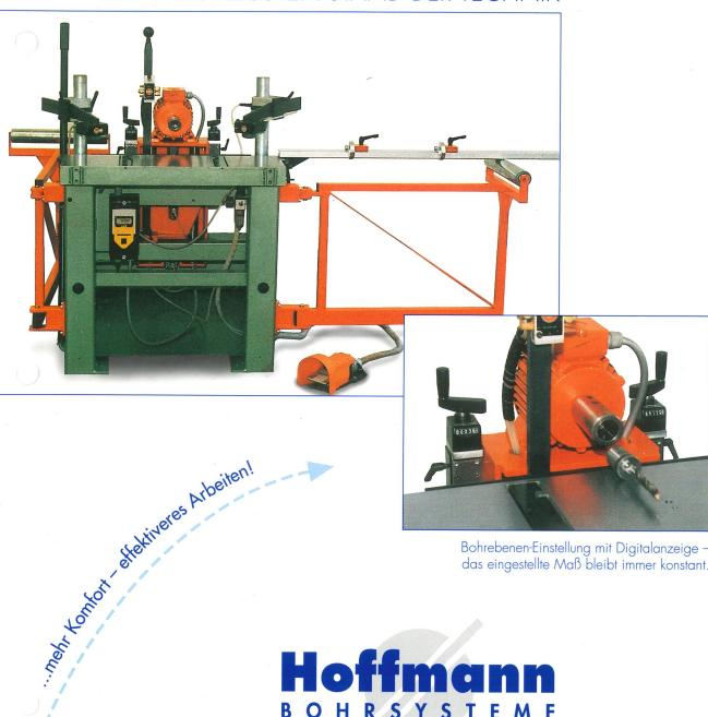
Bohrebenen-Einstellung mit Digitalanzeige das eingestellte Maß bleibt immer konstant.
