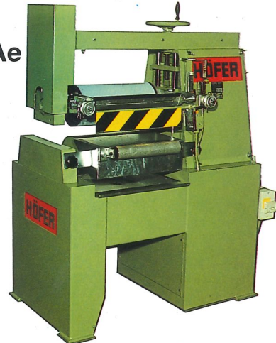
Einseitig offene Auftragsmaschine One-side open gluespreader
