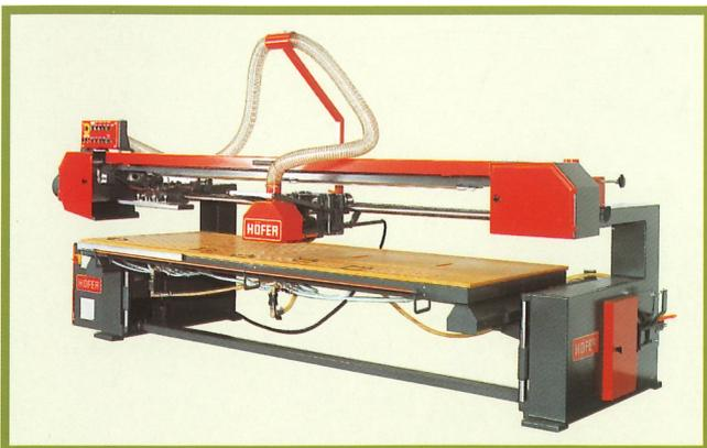
Bandschleifmaschine für Metallbearbeitung mit Zusatz-Polieraggregat, pneumatischer Schleifeinrichtung, Beleuchtung, Bandreinigung, elektrischer Tischhöhenverstellung, frequenzgeregeltem Schleifmotor für stufenlose Bandgeschwindigkeit, Vakuumtisch, etc.
