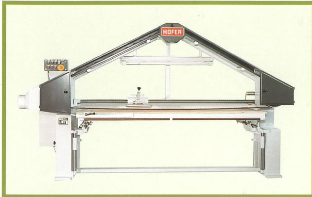
Bandschleifmaschine für Hochglanzpolieren von Polyesterflächen. Frequenzgeregelte Schleifgeschwindigkeit. (Klaviererzeugung). Besonders gute Sicht auf die hochempfindliche Werkstückoberfläche.
