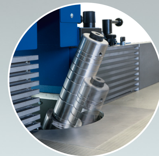
Höhenverstellung erfolgt linear über die Spindel
