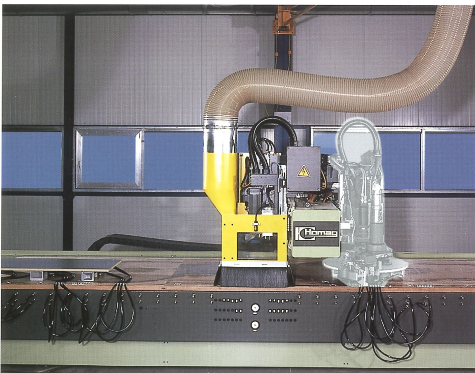
Ausbau des Verleimteils.
