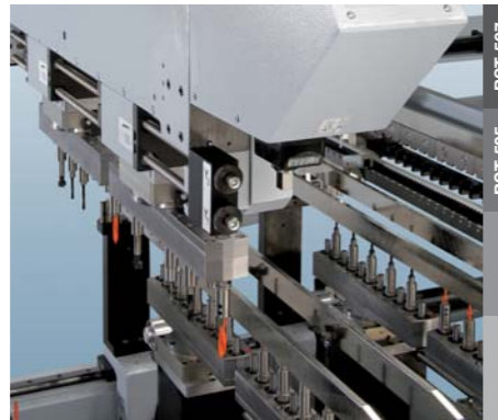
Vertikales Bohren von oben
