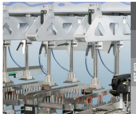
Spannbrücken (nicht schwenkbar)
