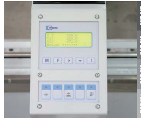
LCD-Positionierhilfe- und -kontrollsystem
