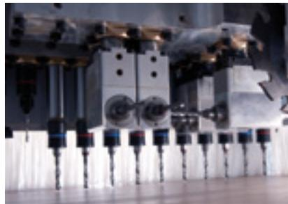
High-Speed-Bohrtechnik mit Nutsäge
