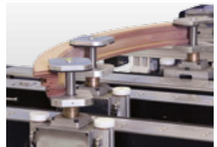
**3-Stufen-Spanner:** Hochsteife 3-Stufen-Spanner mit großer Spannhöhe zur präzisen Komplettbearbeitung von Fenster- und Haustürteilen ohne nachträgliches Umfälen.
