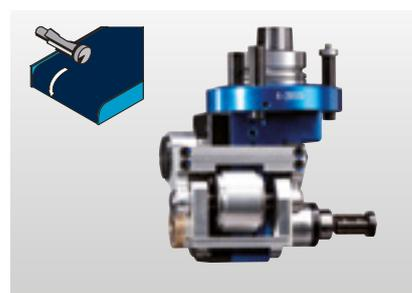
**Fräsaggregat horizontal getastet:** Mittels einer Tastrolle werden Horizontalfräsungen exakt zur Werkstückoberfläche ausgeführt z. B. beim Bündigfräsen von Kantenüberständen am Postformingprofil einer Küchenarbeitsplatte. Die Tastrolle und der Fräser werden hierzu im Durchmesser abgestimmt, in der Regel auf 20 mm.
