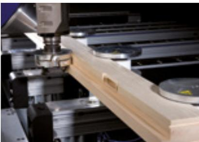
Rahmenteile spannen und profilieren
