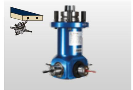
**Bohr-/Fräsaggregat, 2+2 Spindeln:** Durch den 4-seitigen Spindelaustritt stehen vier unterschiedliche Bohr- und Fräswerkzeuge ohne einen Werkzeugwechsel zur Verfügung. Durchgehende Welle für höhere Steifigkeit und die Bearbeitung ohne Drehrichtungswechsel bei Einsatz von rechts- und linksdrehenden Werkzeugen, z.B. für Ausfräsungen für Türbänder.
