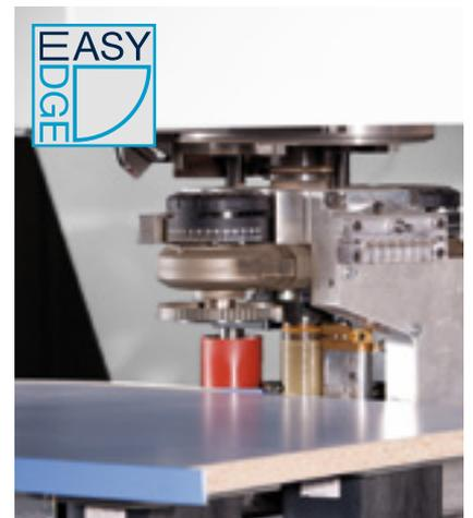
**easyEdge Kantenanleimaggregat:** Die kleinste Kantenanleimmaschine der Welt – preiswert, einfach und effizient. Die universale Lösung für die Bekantung von kleinen Werkstückmengen mit Furnierkanten, ABS-Kanten, PP-Kanten, Melaminkanten PVC-Dünnkanten. In Verbindung mit einem manuellen Kappaggregat sind sogar 360° Stoßkantenanleimung in handwerklicher Qualität möglich.
