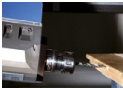
Stufenbohrung für Einbohrbänder
