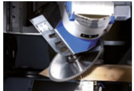
Schifterschnitt mit großer Schnitttiefe für Rahmenteile
