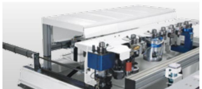
**Linearwechsler:** Zusätzliches Werkzeugwechselfmagazin mit 8/9 Plätzen und integriertem Werkzeugübergabepplatz, seitlich angebaut. Das Magazin nimmt auch den Pick-up-Platz für das optionale easyEdge-Aggregat auf.
