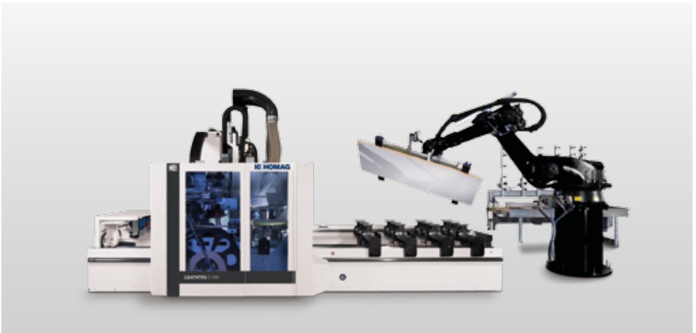
**Roboterhandlungssysteme:** Werkstückhandling ohne Grenzen mit unterschiedlichsten Lagebildern, Lageplätzen, Ausrichten, Wenden. Zusatzfunktionen wie z. B. Etikettierung, Lagevermessung, Reinigung, lassen sich integrieren.
