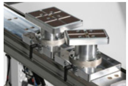
**Vakuumspanner aus Aluminium:** Vakuumspanner aus Aluminium mit zusätzlicher mechanischer Klemmung auf der Konsole zum Aufspannen von Massivholzteilen. Die Saugplatte ist drehbar und austauschbar, Belag aus Schmirgelleinen.
