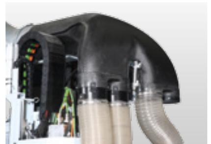
**Energieeffizienz eingebaut:** Effektive Absaugung bei geringer Anschlussleistung durch optimierte Erfassung und Ableitung der Späne. Reduzierter Stromverbrauch durch Stand-by-Betrieb aller Leistungskomponenten auf Knopfdruck oder automatisch nach Zeitintervall. Reduzierter Druckluftverbrauch durch optimierte Pneumatikkomponenten.
