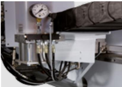
**Abgedeckte Linearführung:** Abgedeckte Linearführungen mit geschlossenen Führungswagen und integrierter automatischer Zentralschmierung aller Achsen. Geschlossene Energieketten zum Schutz von Kabeln und Schläuchen.
