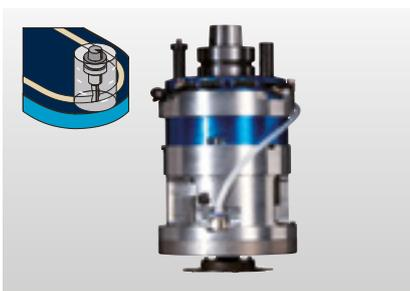
**Fräsaggregat vertikal getastet:** Mittels eines Tastrings mit  $\varnothing 70$  mm bzw.  $\varnothing 130$  mm oder eines Tastschuhs können z. B. Ziernuten und Taschenfräsungen exakt im Verhältnis zur Werkstückoberfläche ausgeführt werden. Bei der Verbindung von Küchenarbeitsplatten garantiert die Tastung einen versatzfreien Übergang durch präzises Fräsen von Nuten für die Federverbindung.
