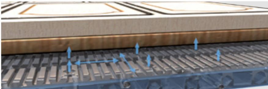
**Vakuum-Rastertisch mit Luftkissenfunktion:** Die Übertragung des Vakuums ist in die Konstruktion des Aluminiumrastertisches integriert. Zonenteilung und leistungsfähige Vakuumpumpen sorgen für sichere Spannung, auch bei Nesting-Bearbeitung mit Unterlegplatten. Durch die Luftkissenfunktion fällt das Handling großformatiger plattenförmiger Werkstücke leicht.
