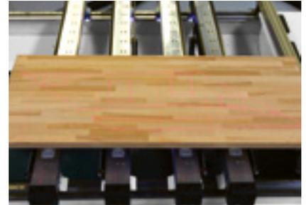
**Laserprojektion:** Laserprojektion der Spannmittel und der Werkstückkontur für optimale Ausnutzung und einfaches Auflegen von Rohteilen, die nicht an den Anschlägen ausgerichtet werden können.
