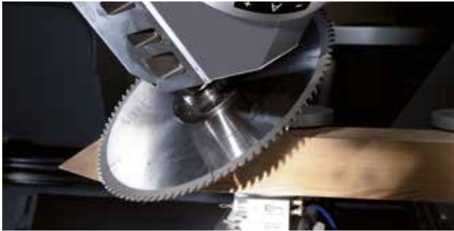
Schifterschnitt mit großer Schnitttiefe für Rahmenteile
