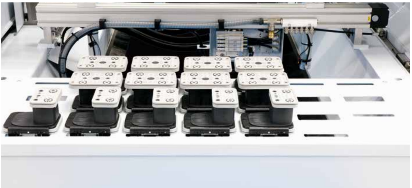
Saugerablageplatz Seitlich in die Maschine integrierter Ablageplatz für Vakuumsauger zum einfachen und schnellen Zugriff
