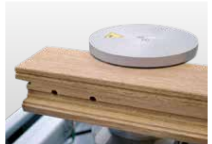
PowerClamp z.B. für die 6-seitige Bearbeitung von Massivholzkomponenten (absenkbare Grundplatte)
