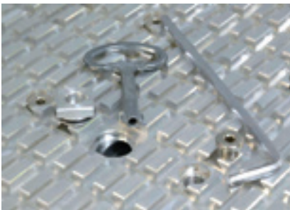
1" Vakuumanschlüsse mit Schnellöffnung mittels Schaltschrankschlüssel, Vakuumöffnungen mit Feingewinde zur Befestigung von Spannmitteln
