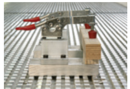
Befestigung von Sonderspannmitteln Der Aluminiumrastertisch mit Schwabenschwanzführungen gewährleistet die präzise formschlüssige Spannelementfixierung
