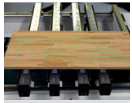
Laserprojektion der Spannmittel und der Werkstückkontur für optimale Ausnutzung und einfaches Auflegen von Rohteilen, die nicht an den Anschlägen ausgerichtet werden können.
