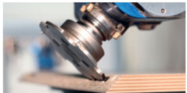
Ausfräsungen für Verbindungsbeschläge
