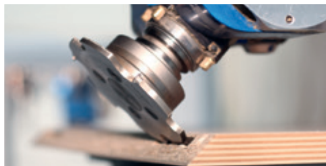
Ausfräsungen für Verbindungsbeschläge
