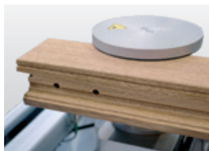
PowerClamp z.B. für die 6-seitige Bearbeitung von Massivholzkomponenten (absenkbare Grundplatte)
