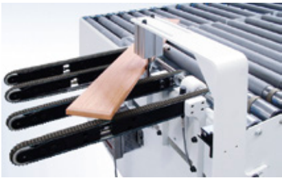
Drehbolzen für Schmalteile Sensorgesteuert (optional)
