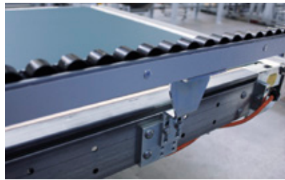
Röllchenleiste zur Unterstützung breiter Werkstücke (optional)
