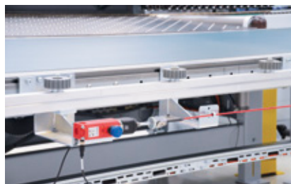
Ausrüstung für CE Konformität: Reißleine längs zum Rückführband
