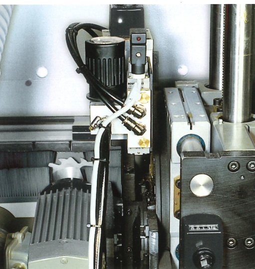
Universalfräsaggregat UF 11 Zum Nuten, Fälzen und Profilieren mit schwenkbarem und gesteuertem Motor.
