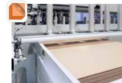
**Automatische Einzelblattzuführung mit Hubtisch** ermöglicht die automatische Zuführung gestapelter Einzelblattware.
