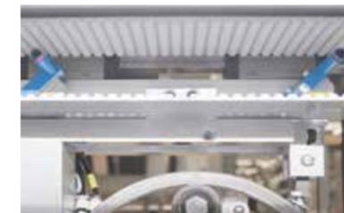
Die **Werkzeugkollisionsüberwachung** verhindert die Kollision und damit Beschädigung von Werkzeug und Kartonage.
