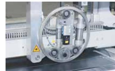
**Servicefunktionen:** Nach einem Werkzeugwechsel werden die neuen Werkzeuge automatisch kalibriert. Nach 100 Zuschnitten erfolgt eine dynamische automatische Werkzeugpositionierung, um den Verschleiß der Gummiwalze zu minimieren.
