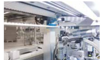
Eine **permanente Positionsüberwachung der Längswerkzeuge** und automatische Positionskorrektur sichern das designgerechte Verfahren und die Ausführung der Schnitte.
