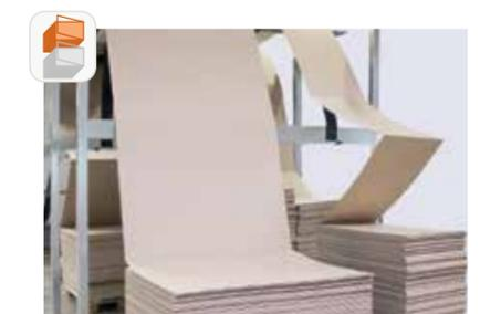
In der Betriebsart **Side by Side** wird das Kartonagenzuführfach um eine weitere Bahnbreite erweitert, sodass bei einem 6-Fach-Wechselsystem bis zu 12 Bahnbreiten im Einzelzugriff möglich sind.
