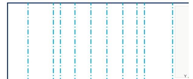
Die Zuschnitte für dieses Beispiel werden vollständig geschnitten und gerillt, sodass das Produkt einfach und schnell versandfertig gemacht werden kann (Grafik: Zuschnitt mit Rillung für das Innenpolster des Vasenkartons)
