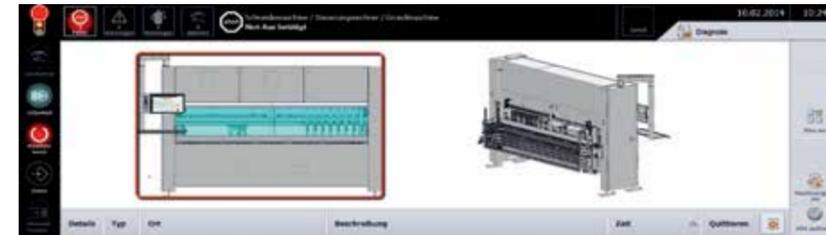
Das integrierte **Fehlerdiagnosesystem** analysiert alle Arbeitsgänge, meldet notwendige Wartungen, den Austausch von Verschleißteilen (Schneidmesser), u. Ä., um jederzeit eine gleichbleibend hohe Qualität zu gewährleisten und Stillstandzeiten zu vermeiden.
