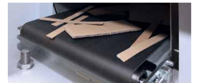
Die automatische Entsorgung der Schneidreste fördert die Prozessstabilität und reduziert Stillstandzeiten der Maschine.
