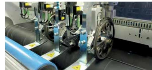
Auf Gummirollen laufende Werkzeuge sorgen für geringere Schneidkräfte und weniger Verschleiß bei bester Schnittqualität und langer Werkzeuglebensdauer.
