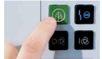
Die **ecoPlus-Taste** unterbricht die Produktion und überführt die Maschine in den Energiesparmodus.
